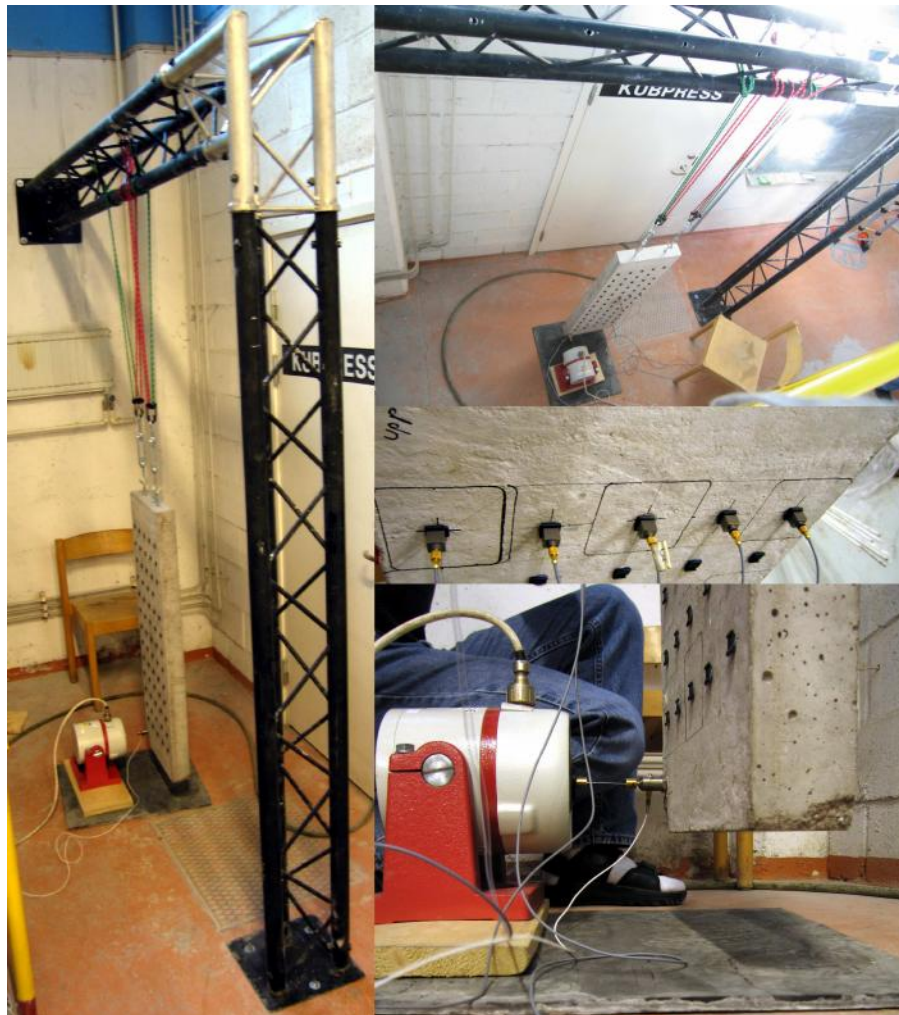
Figur 4: Mätningar på fritt hängande armerad betongplatta.
